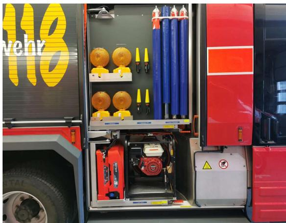
Achtet beim mitnehmen darauf, dass ihr den Lüfter vom Strom trennt. Der Lüfter wird im Depot direkt über das Fahrzeug mit elektrischer Energie versorgt.
