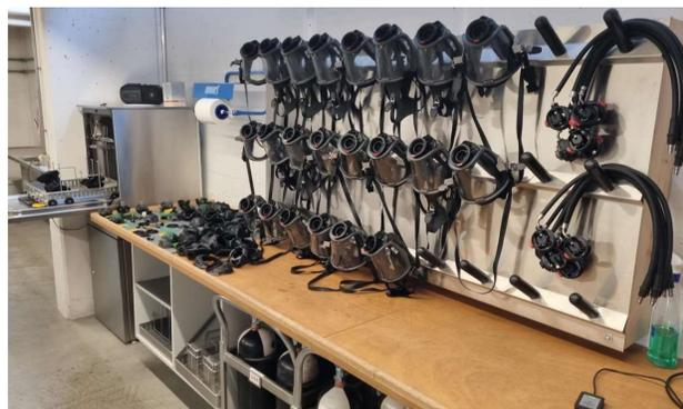
Nach jeder Übung werden die Masken und Lungenautomaten zerlegt, gewaschen, wieder zusammgebaut und anschliessend auf dem
